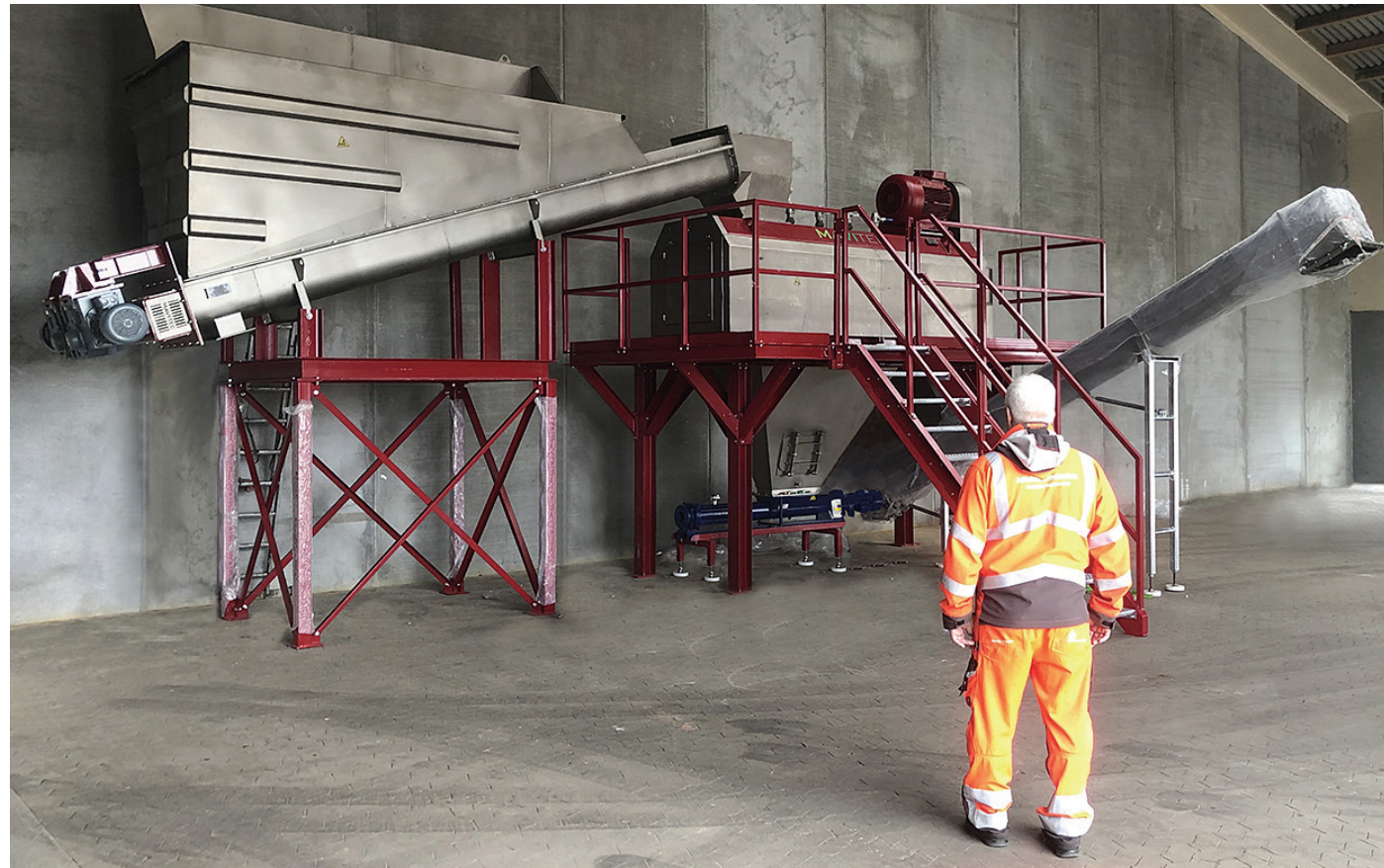
LSH-Biotech har leveret et komplet affalds-forarbejdsanlæg (såkaldt Mavitec Paddle Depacker anlæg). Anlæggene tilpasses lokale og konkrete forhold mht affaldsmængde med mere og kan med fordel kan placeres decentralt eks. ved et eksisterende biogasanlæg
